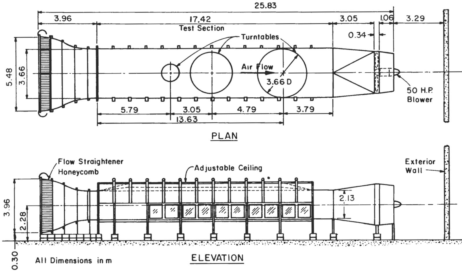
Fig. 1. ENVIRONMENTAL WIND TUNNEL
