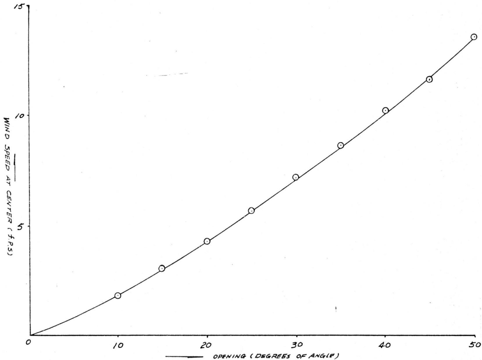
FIGURE 6 BLOWER OPENING AGAINST WIND SPEED.
