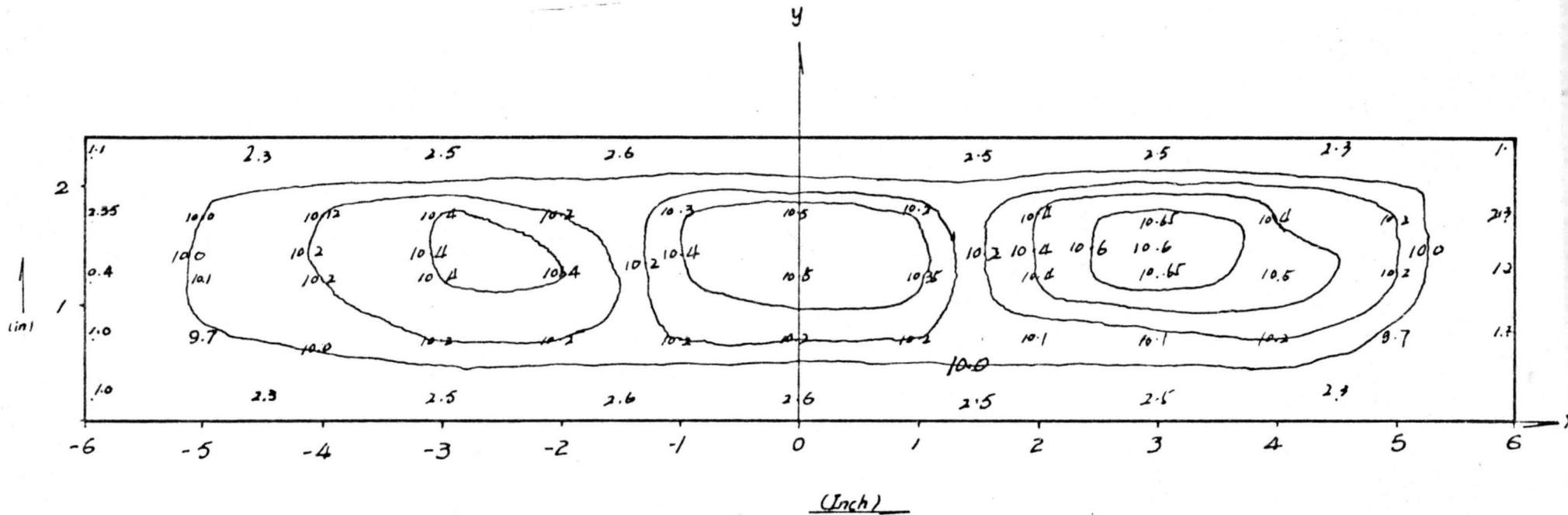
FIGURE 7 VELOCITY DISTRIBUTION AT THE END OF THE
