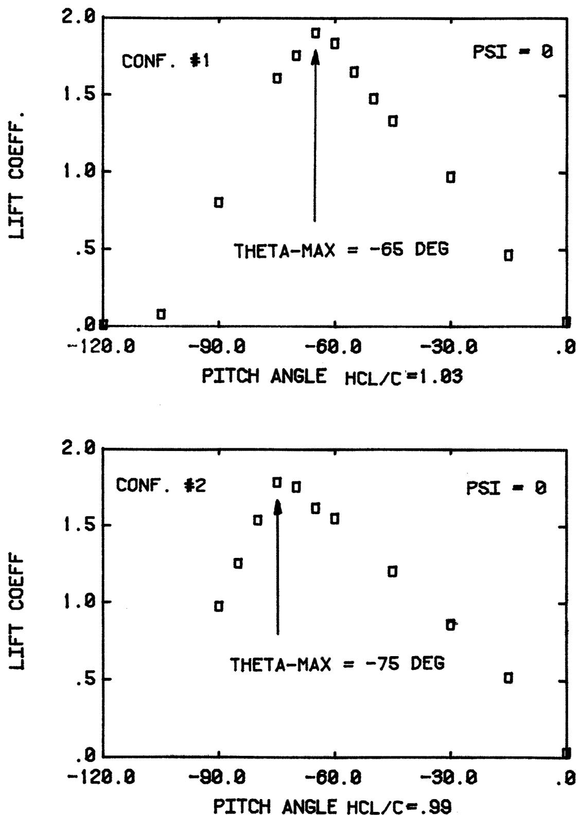
Figure 9a. Determination of  $\theta_{\max}$  (configurations 1-4).
