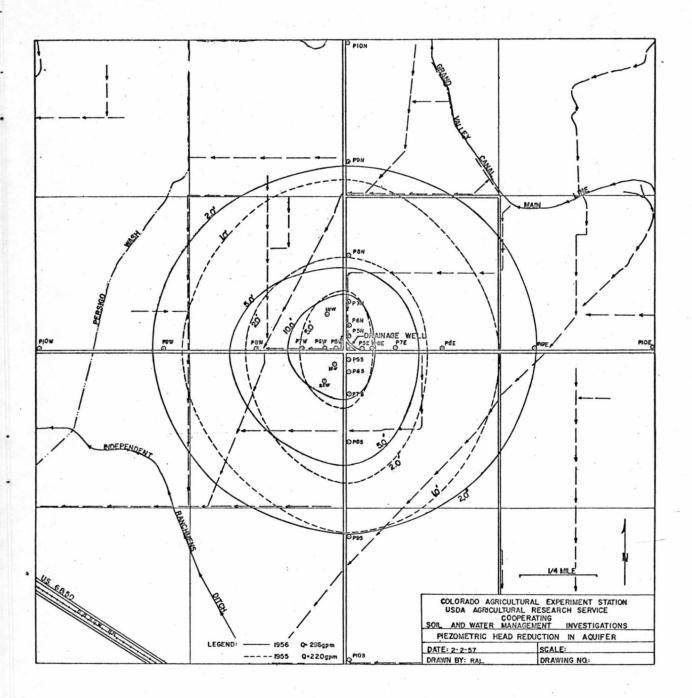
Fig. 5. PRESSURE REDUCTION IN AQUIFER.
