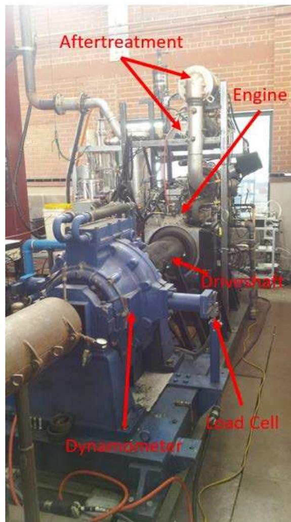
**Figure 12. Engine & Dynamometer Test Stand**
