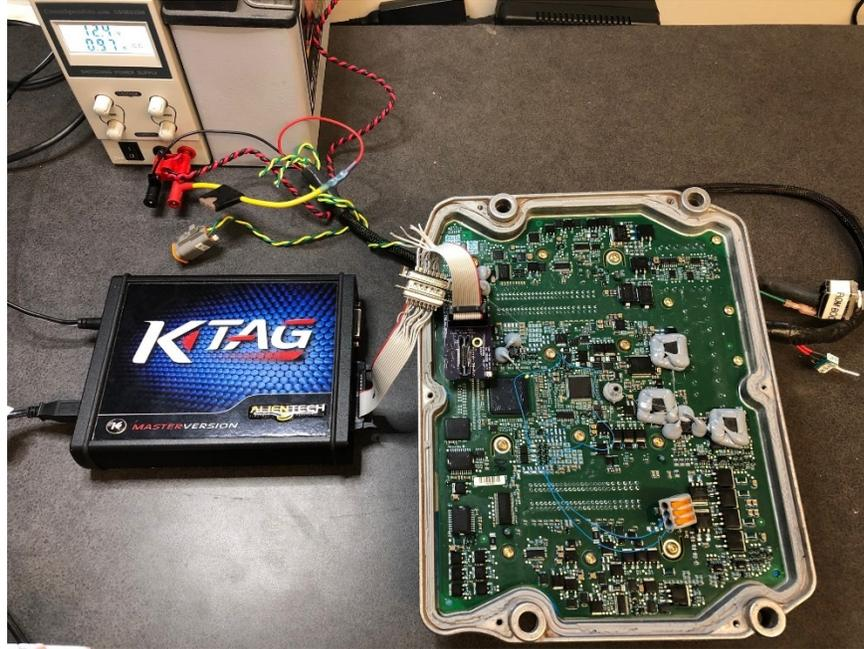
**Figure 41. KTAG Reflash Setup**
