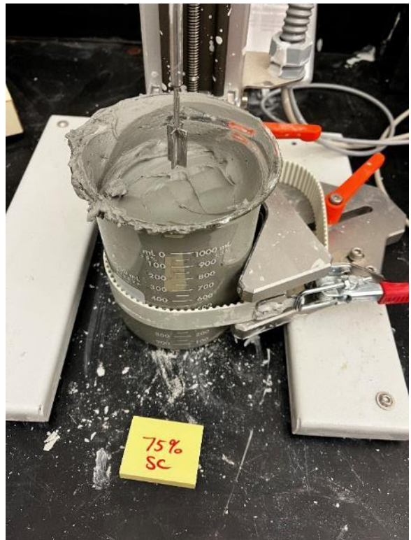
Photo 8. Mini vane shear at 75% SC
