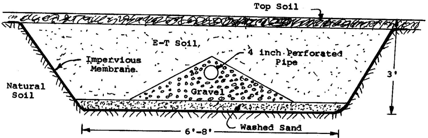
FIGURE 19 TYPICAL EVAPO-TRANSPIRATION TRENCH OF BED
