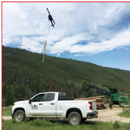
Helicóptero arrastrando troncos hacia un punto de aterrizaje. Foto: CSFS
