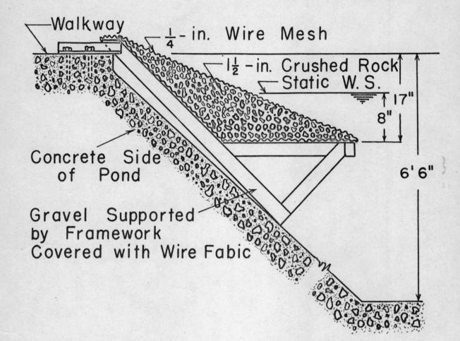
Fig. 2 CROSSECTION OF GRAVEL-BEACH WAVE ABSORBER
