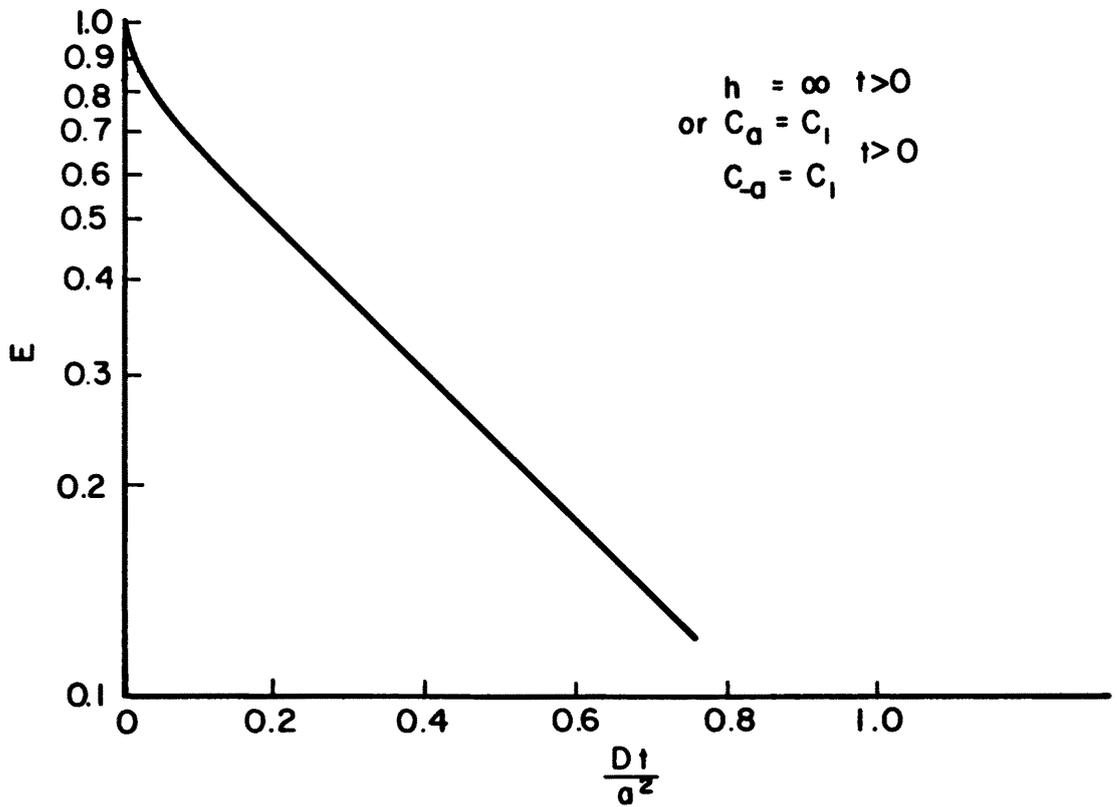
FIGURE 2: MOISTURE GRADIENTS FOR ZERO SURFACE RESISTANCE AND UNIFORM INITIAL MOISTURE DISTRIBUTION
