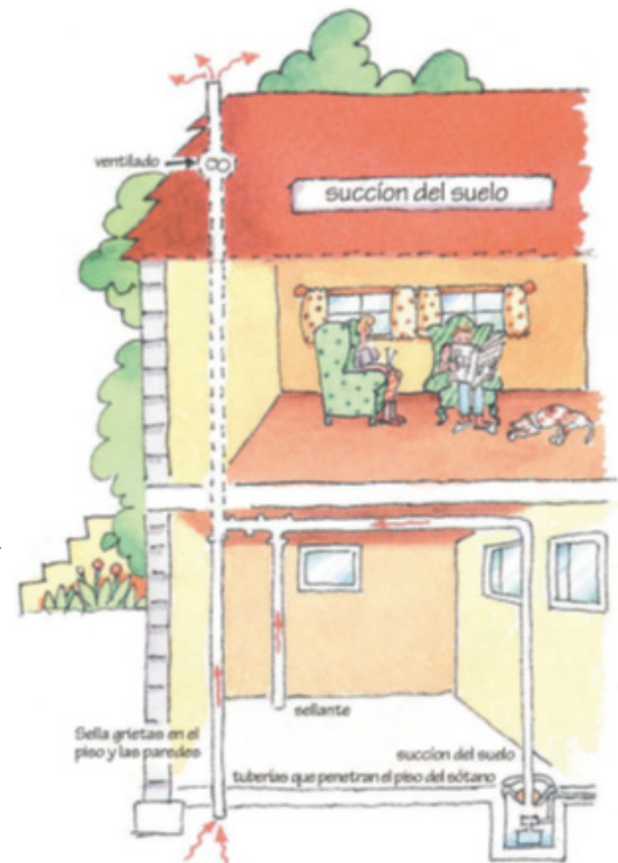
Figura 4 : Sistema típico de mitigación del radón (EPA).
