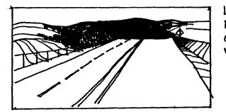
LONG STRAIGHT TANGENT SECTION ENCOURAGES HIGHER SPEEDS ONLY TO CHANGE ABRUPTLY WITH LITTLE WARNING.
